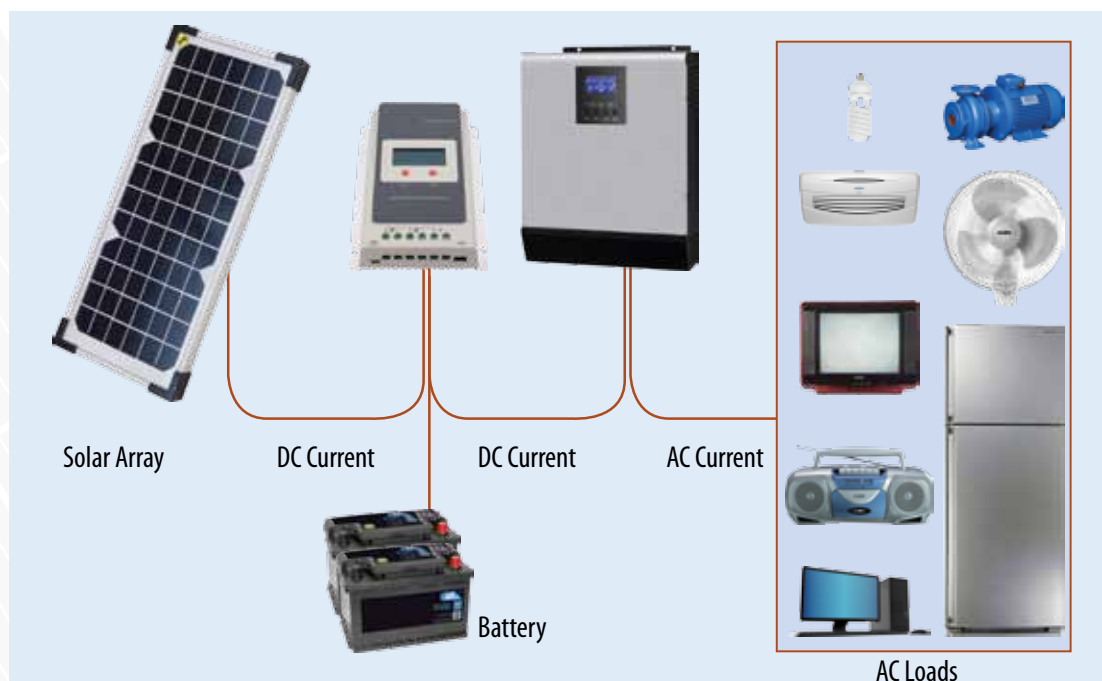
الشكل ٣٦: يوضح الإطار العام لأي نظام يستعمل الخلايا الشمسية كمصدر للطاقة
